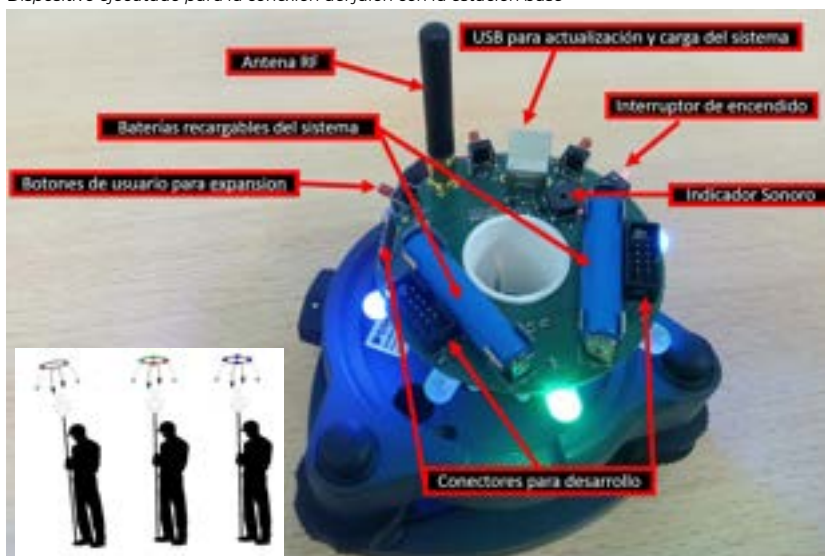
Dispositivo ejecutado para la conexión del jalón con la estación base
