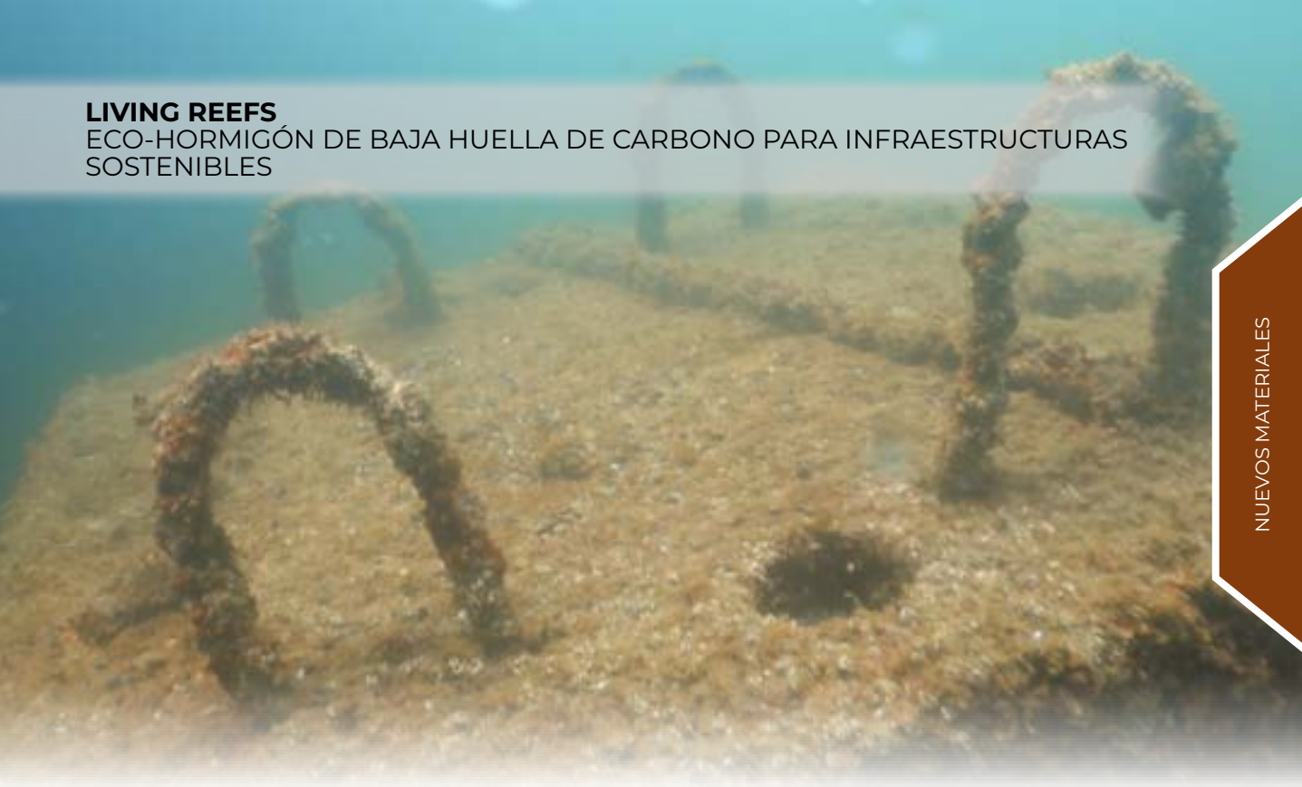
Imagen del piloto después de varios meses sumergido en el Puerto de Sagunto
